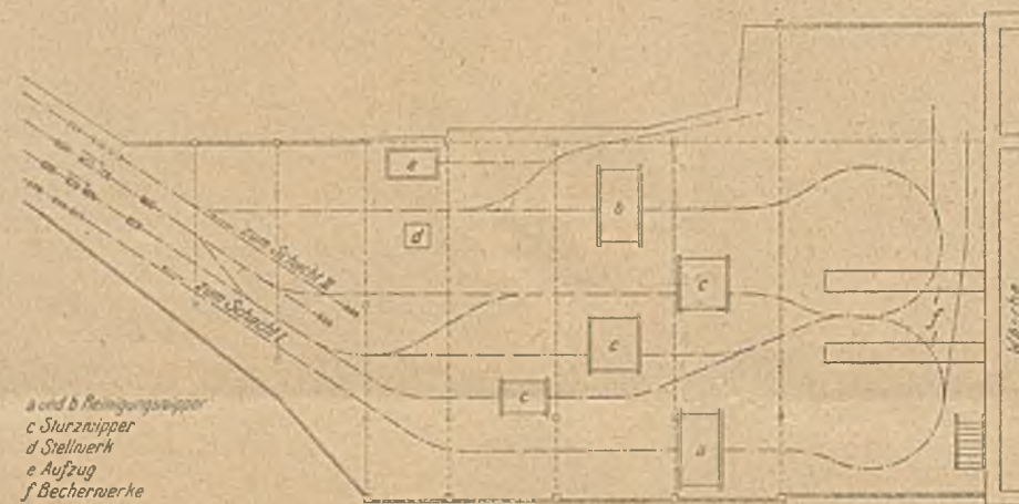
Abb. 3. Wagenumlauf mit Reinigungsanlage.
