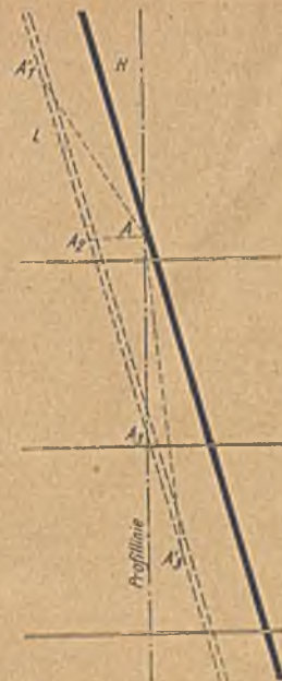
Abb. 7. Verwerferbild der Störung a in Abb. 5.
