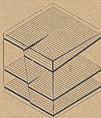
Abb. 13. Ausklingen eines Sprunges nach der Seite und nach der Teufe.
