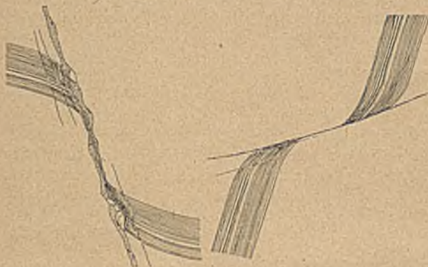
Abb. 10. Kluftbeschaffenheit eines Sprunges und einer Überschiebung.
