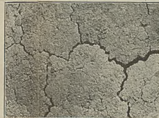
Abbildung 7. Wandfläche von Koks bei kaltem Ofengang.
