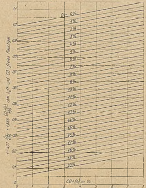
Abb. 12. Luft- und CO-freie Rauchgasmenge für vollkommene Verbrennung.
