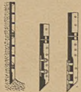
Abb. 8. Unterer Teil eines gußeisernen Senkschachtes.
