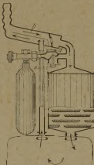
Abb. 1. Schema des Heeres-Sauerstoff-Schutzgerätes.
