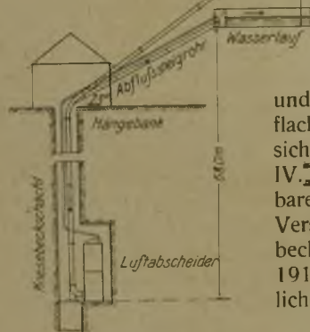
Abb. 2. Erste Ausführung der Hydrokompressoranlage am Knesebeckschacht.
