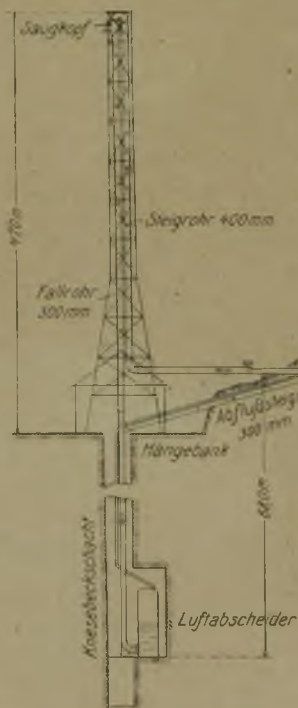
Abb. 3. Umgestaltete Hydrokompressoranlage am Knesebeckschacht.
