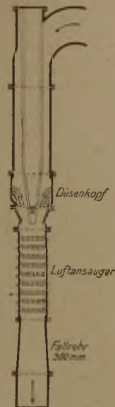
Abb. 4. Erste Ausführung des Saugkopfes am Knesebeckschacht.
