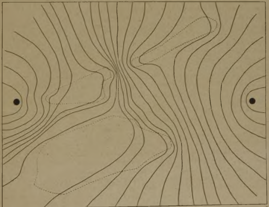
Abb. 4. Elektrische Potentiallinien in einem Gebiet mit Stellen erhöhter Leitfähigkeit.
