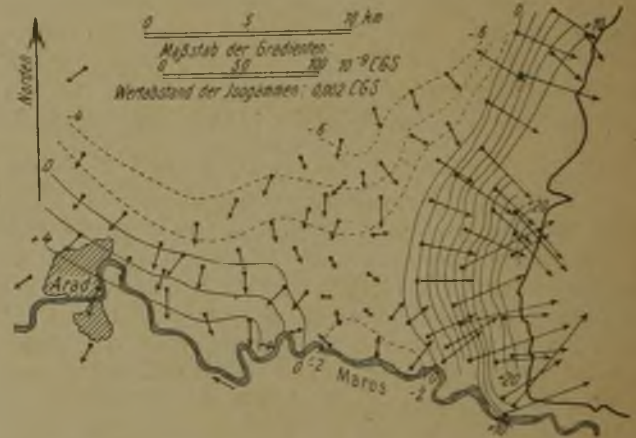
Abb. 1. Verteilung der Isogammen und Gradienten der Schwerkraft in der Gegend von Arad.
