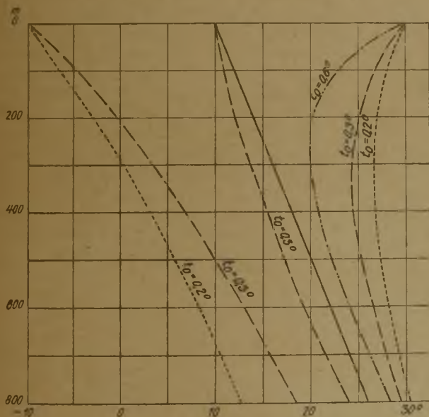
Abb. 6. Temperaturänderung des einfallenden Wetterstromes durch Wärmeaustausch und Selbsterwärmung bei einer Gesteintemperatur von 10–26°.
