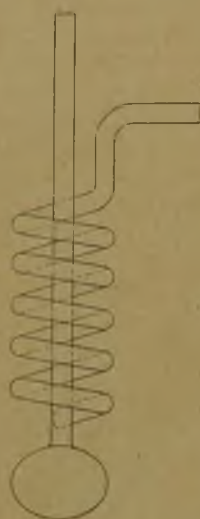
Abb. 8. Ungeeignete Form einer Rohrschleife zum Ausfrieren des Benzols.
