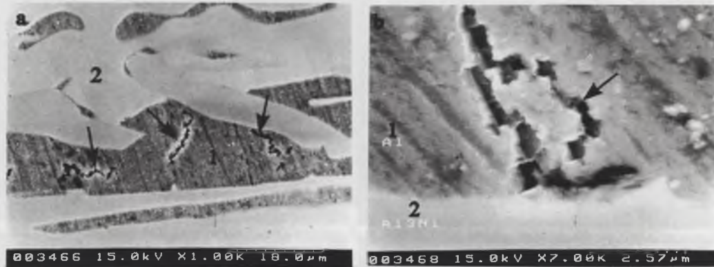
Rys. 85. Mikrostruktura kompozytu typu LAI(Ni)_p , w którym prekursorem nowej fazy był gruboziarnisty proszek Ni o nieregularnej budowie: a) i b) na powierzchni rozdziału osnowa Al (1) – faza Al_3Ni (2) zaznaczone strzałkami, regularne pory powstałe w wyniku efektu Kirkendalla-Frenkla; SEM Fig. 85. SEM micrograph of the LAI(Ni)_p composite (coarse-grained Ni powder of irregular shape used as the new phase precursor): a) and b) at the Al matrix (1) – Al_3Ni (2) interface visible regular pores formed as a result of the Kirkendall-Frenkel effect (indicated by arrows)
