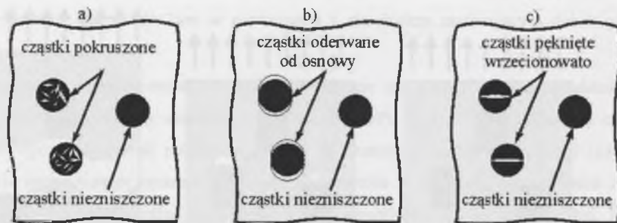
Rys. 5. Model Tonga i Ravichandrana ilustrujący zachowanie się cząstek sferycznych podczas dekohezji kompozytu PRMMCs: a) fragmentacja cząstek w całej objętości, b) oddzielanie się cząstek od osnowy, c) pęknięcie cząstek w wyniku utworzenia pojedynczej pustki [75]
