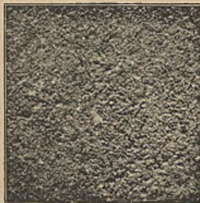
Abb. 5. Geschliffene Bruchfläche von Preßkoks. v = 45 .
