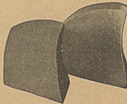
Abb. 4. Neue und abgenutzte Hela-Picke.
