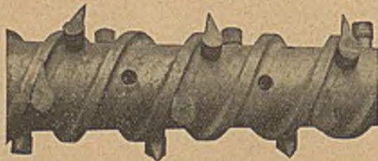
Abb. 2. Schrämstange mit Spitzpicken.
