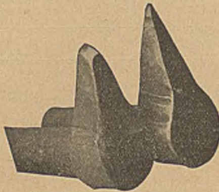
Abb. 1. Neue und abgenutzte Spitzpicke.
