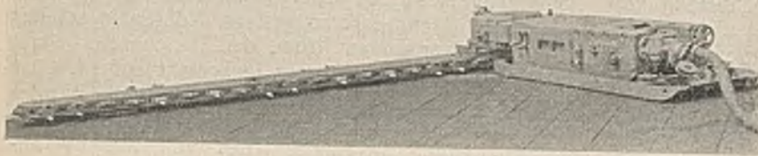
Abb. 1. Langarmschrämmaschine von Eickhoff.
