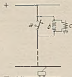
Abb. 5. Allein- und Parallelbetrieb (Spannungsabfallmessung am Widerstand).
