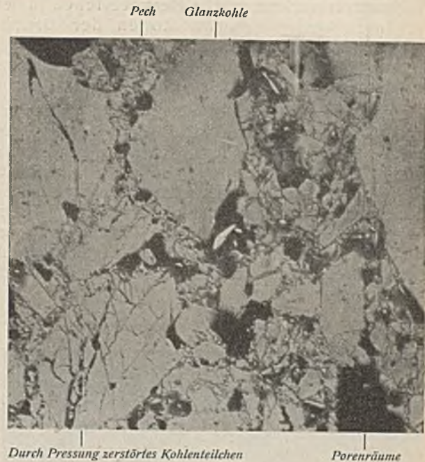
Abb. 3. Zerkleinerung der Glanzkohleteilchen beim Preßvorgang (Bruchlinien vom Pech nicht ausgefüllt). v = 180 .
