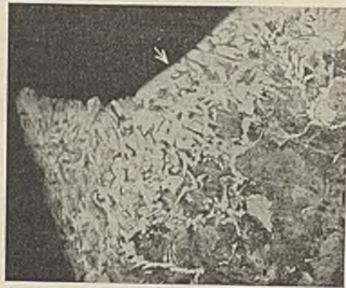
Abb. 9. Gefüge in der Umgebung des Bruchansatzes eines bei b gebrochenen Bohrers. v = 120 .
