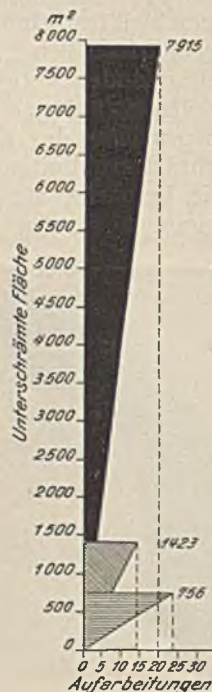
Abb. 8. Bis zum endgültigen Verbrauch eines Satzes unterschramte m 2 und Anzahl der Aufarbeitungen.
