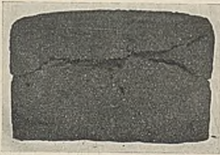
Abb. 14. Schwelkoks von Kohle 7, schwärzlich und eben gesintert.
