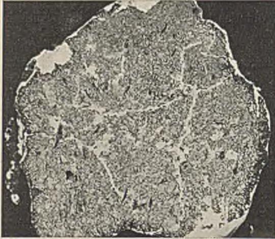
Abb. 11. Koks mit ziemlich rißfreiem, einheitlichem Gefüge.
