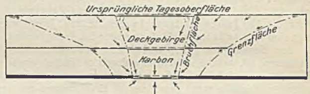
Abb. 5. Verlauf der Gebirgsbewegung über dem Abbau.
