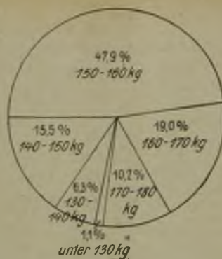
Abb. 4. Bezirk Bonn (Erz). Abb. 5. Bezirk Dortmund (Steinkohle). Abb. 6. Bezirk Breslau (Steinkohle). Abb. 4-6. Verteilung der Seile nach Bruchfestigkeiten.
