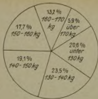
Abb. 4. Bezirk Bonn (Erz). Abb. 5. Bezirk Dortmund (Steinkohle). Abb. 6. Bezirk Breslau (Steinkohle). Abb. 4-6. Verteilung der Seile nach Bruchfestigkeiten.
