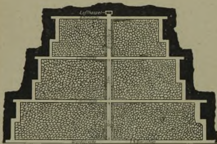
Abb. 2. Zweiflügeliger Abbau eines Bremsbergfeldes mit schwebenden Stoßörter.
