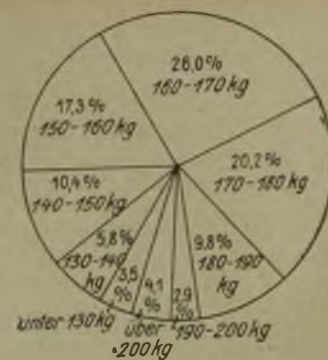
Abb. 4. Bezirk Bonn (Erz). Abb. 5. Bezirk Dortmund (Steinkohle). Abb. 6. Bezirk Breslau (Steinkohle). Abb. 4-6. Verteilung der Seile nach Bruchfestigkeiten.
