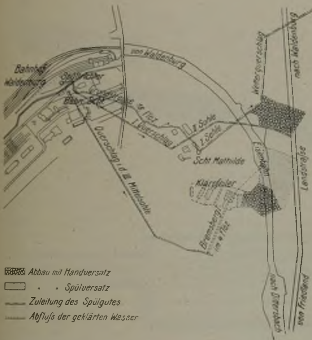
Abb. 2. Lage der Klärpfeiler zu den Spülversatzbauten.
