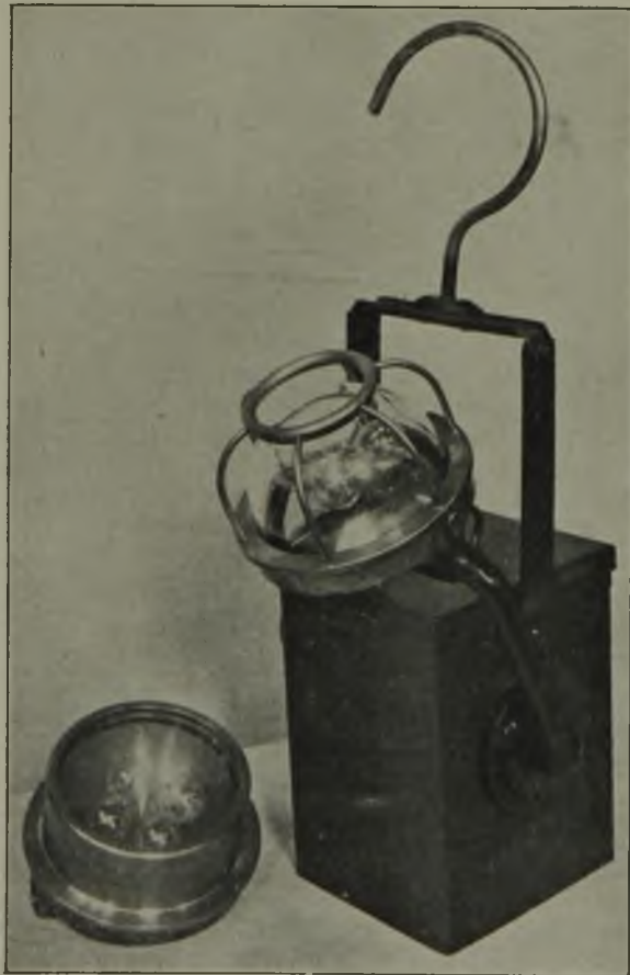
Abb. 1. Tragbare elektrische Firsten- und Abteuflampe.
