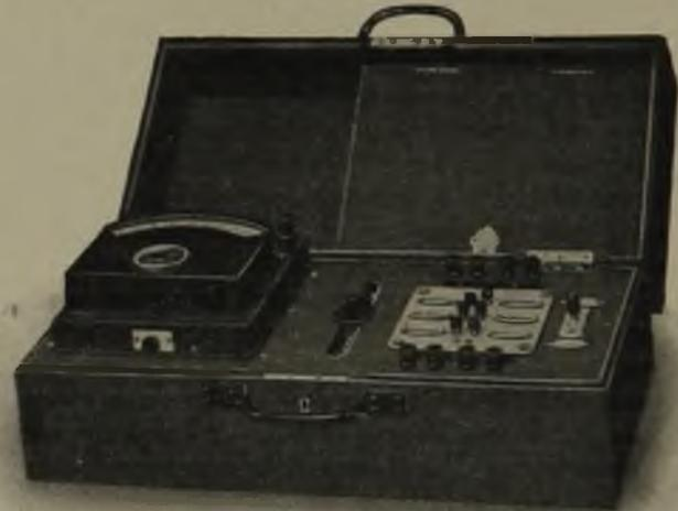
Abb. 7. Tragbarer Fernanzeiger für Dampfkessel-Überwachungsvereine von Siemens & Halske.
