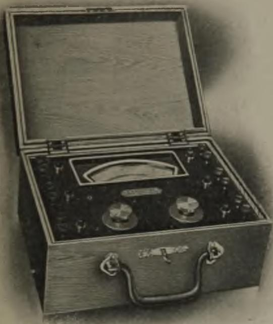
Abb. 1. Tragfähige Ablesevorrichtung für elektrische Fernthermometer von G. A. Schultze.
