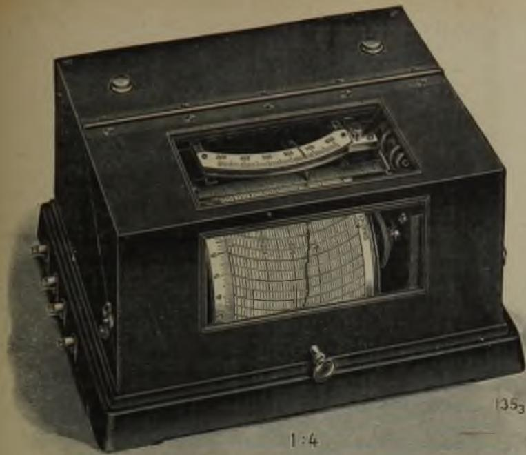
Abb. 6. Aufzeichnende Temperaturanzeigevorrichtung mit Skala und Zeiger für unmittelbare Ablesung von Hartmann & Braun.
