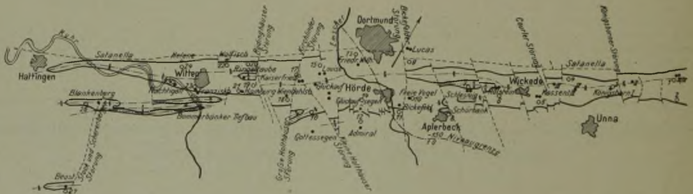
Abb. 1. Verlauf der Geitling- und Kreftenscheerflöze in der Wittener Mulde in den Höhenlagen \pm 0 und -150 m.
