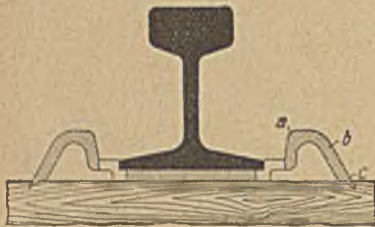
Abb. 30. Schienenbefestigung von Höing, Essen (ältere Bauart).
