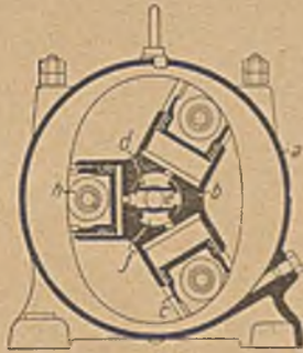
Abb. 7. Querschnitt durch den Schleuderkolbenmotor der Eisenhütte Westfalia. Maßstab 1:10.
