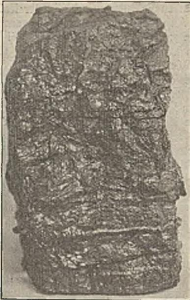
Abb. 7. Schwelkoks aus Kohle mit geringem Gehalt an schmelzenden Bestandteilen.
