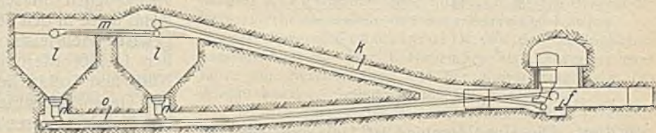
Abb. 4. Vorratsbehälter am Füllort.
