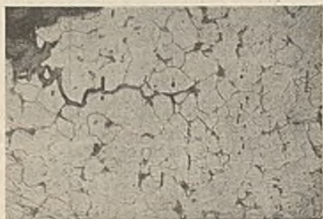
Abb. 6. Vom Anriß interkristallin in den Werkstoff verlaufender alter oxydbedeckter Riß. v. = 150.
