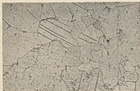
Abb. 5. Grobes Randkorn mit Gleitlinien. v. = 150.
