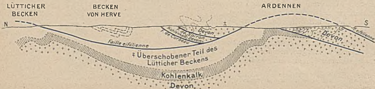
Abb. 4. Schnitt durch das Becken von Herve. (Nach Fourmarier.)
