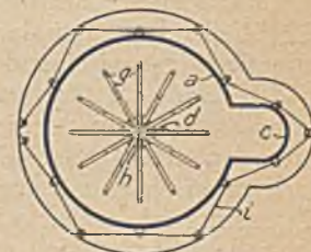
Abb. 7. Wagerechter Schnitt durch den Ofen von Scheitlin zur elektrolytischen Darstellung des Natriums.
