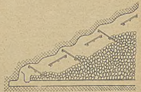
Abb. 14. Rutschenlage während der Gewinnung des Bergemittels
