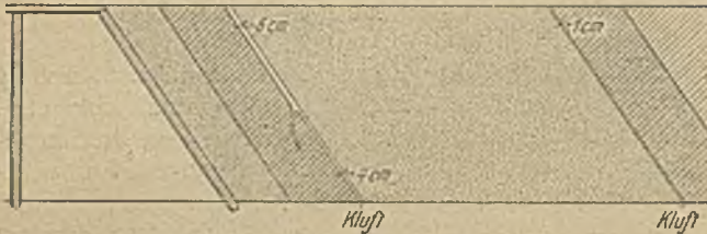
Abb. 1. Absinken von Gebirgsschichten in einem Ortsquerschlag über einem abgebauten Flöz.
