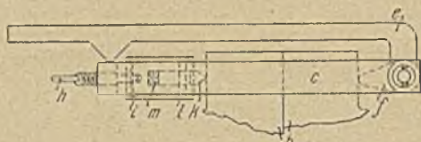
Abb. 42. Grundriß der Kniehebelverbindung mit Federung von Gebr. Hinselmann.
