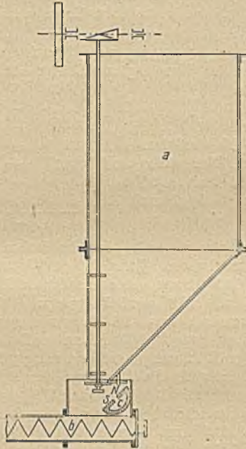
Abb. 20. Magnetausscheider der Rösttrommel.
