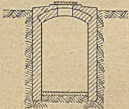
Abb. 49. Querschnitt des neuen Fuchskanals.
