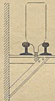
Abb. 55. Prüfbahn für den Stöpselverschluß.
