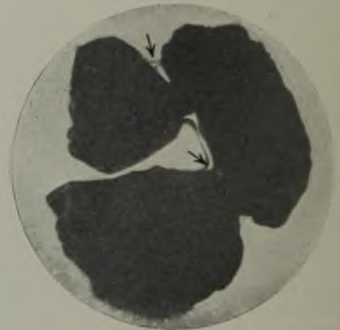
Abb. 2. Kapillarwasser an den Berührungsstellen zwischen Kohlenkörnern der Kornklasse 0,75–1,6 mm. v = 21 .
