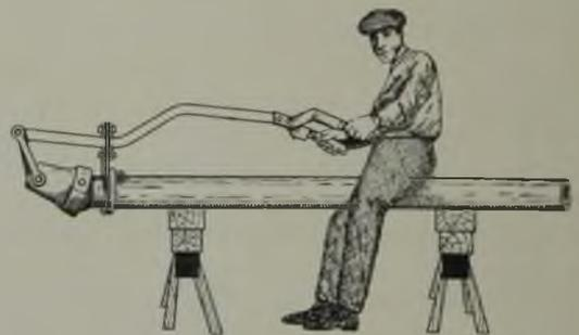
Abb. 14. Schwenkstück für den Austrag der Kugeln.
