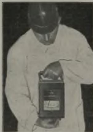
Abb. 2. Einstellung des Statoskopes am Hauptkreis.
