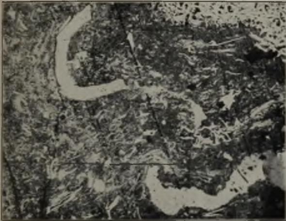
Abb. 5. Faseriger Brandschiefer mit regellos angeordneten Gemengteilen und viel feinem Fusit. Zeche Auguste Victoria, Flöz Sonnenschein. Senkrechter Schliff.  $v = 190$ .
