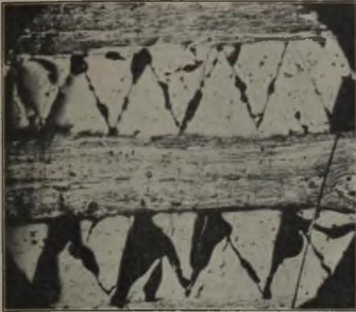
Abb. 3. Vitrit mit bemerkenswerten Rissen; Mineralsubstanz ausschließlich in den Duritstreifen. Zeche Alter Hellweg. EBkohle. Senkrechter Schliff.  $v = 34$ .
