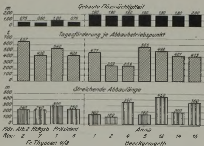
Abb. 3. Zusammenhang zwischen Flözmächtigkeit, Tagesförderung je Abbaubetriebspunkt und streichender Abbaulänge auf den Schachtanlagen Friedrich Thyssen 4/8 und Beckerwerth im August 1932.
