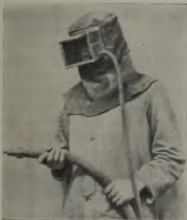
Abb. 13. Schutzhaube aus Leder mit Frischluftzuführung.
