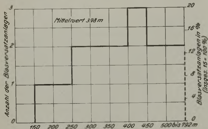
Abb. 4. Länge der Blasrohrleitung je Torkretanlage.
