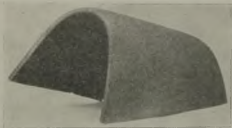
Abb. 7. Verformung einer Kupferplatte durch den Sandstrahl (6 min, grober Rheinsand).
