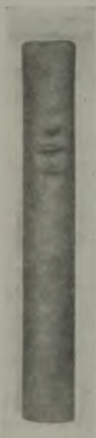
Abb. 8. Verformung eines Kupferrohres durch den Sandstrahl (10 min, grober Rheinsand).
