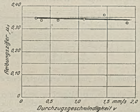
Abb. 8. Versuchsergebnisse entsprechend Abb. 7 bei Bewegung auf »Blei«.
