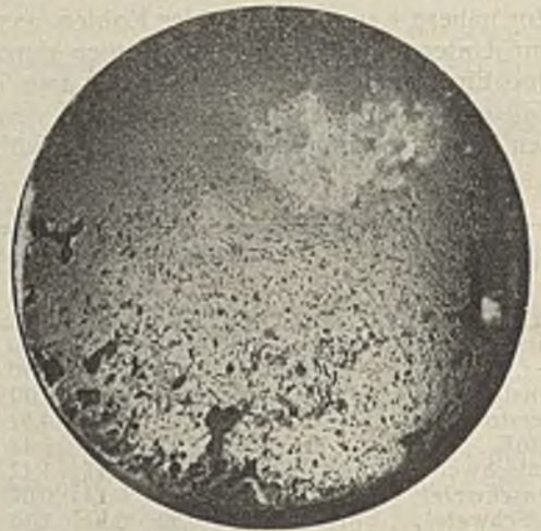
Abb. 2. Oberfläche des geschliffenen und reliefpolierten Aschenzylinders der Mattkohle. v = 3.
