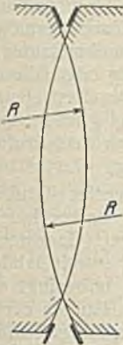
Abb. 2. Radien der Kugelringflächen und des Radkörpers.
