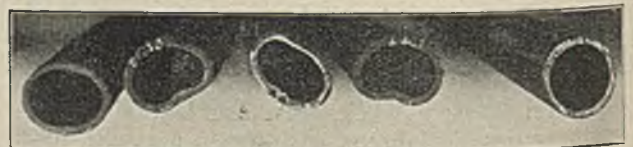
Abb. 5. Durch treibende Kohle zusammengedrückte Rohre von Thermoelementen.
