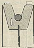
Abb. 3. Unmittelbare Druckübertragung von dem einen auf den anderen Seitenring.
