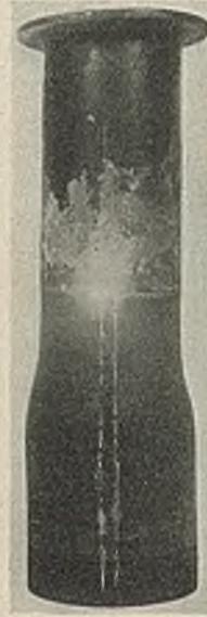
Abb. 18. Zur Hälfte gebeiztes Rohrstück mit Anrissen in der Walzhaut.
