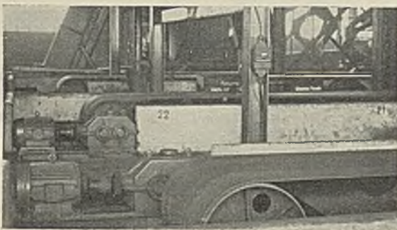
Abb. 12 und 13. Einzelantriebe in einer Aufbereitungsanlage.
