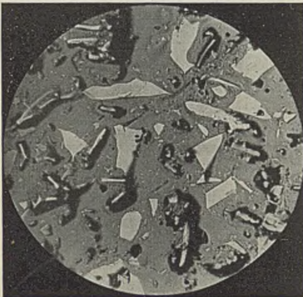
Abb. 5. Kollektiv-Flotationskonzentrat aus Rohstaub einer englischen Kohlengrube (Yorkshire). v = 180 , trocken.
