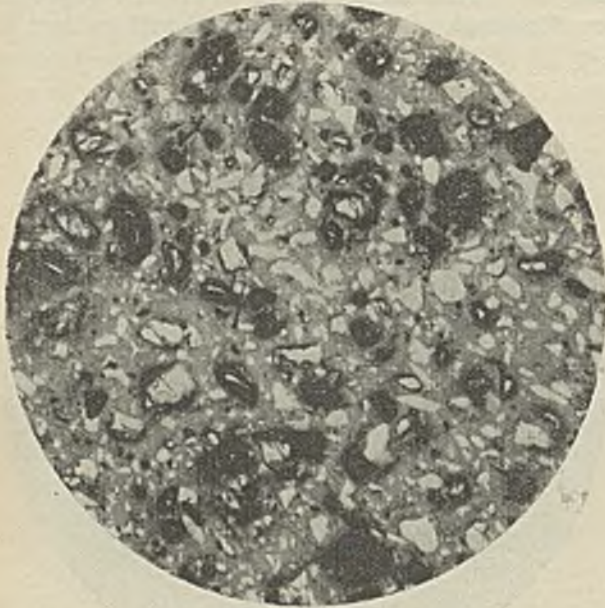
Abb. 12. Vitrit-Selektiv-Flotationskonzentrat aus Staub der Ruhrzeche H. v - 70, trocken.
