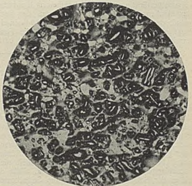
Abb. 11. Fusit-Selektiv-Flotationskonzentrat aus Staub der Ruhrzeche F. v = 70 , trocken.
