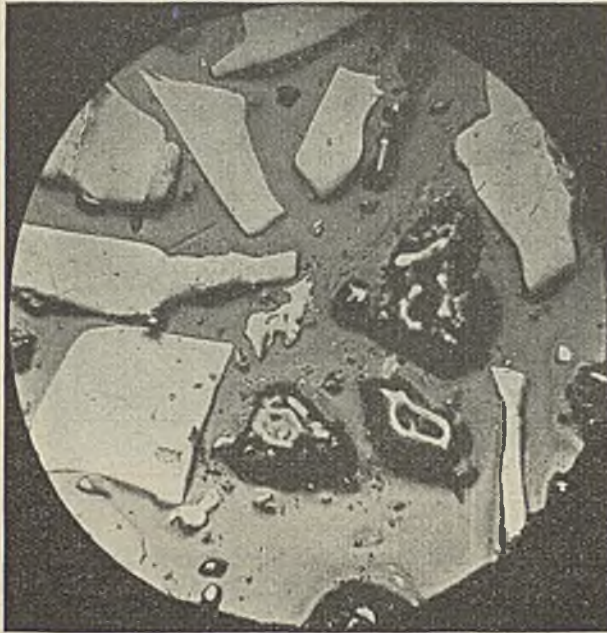
Abb. 1. Vitrit-Selektiv-Flotationskonzentrat aus Kohlenschlamm der Ruhrzeche L. v = 180, trocken.
