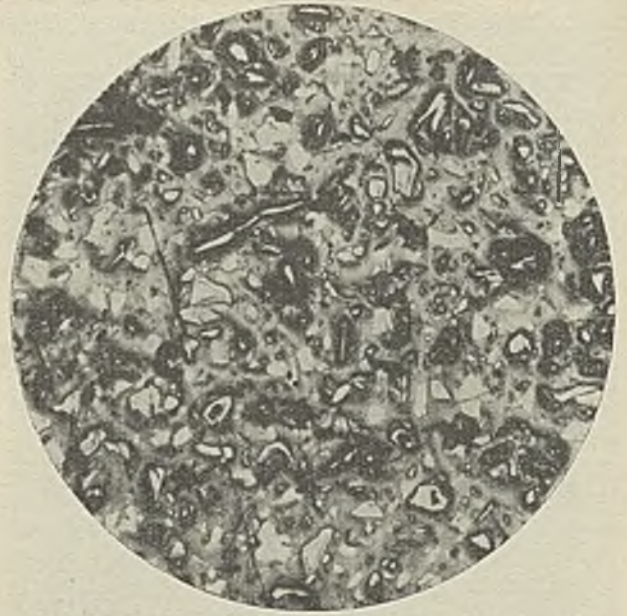
Abb. 13. Fusit-Selektiv-Flotationskonzentrat aus Staub der Ruhrzeche H. v - 70, trocken.
