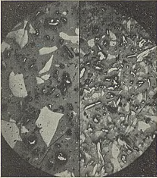
Abb. 8. Rohstaub und Siebstufe unter 10000 M./cm 2 dieses Staubes der Ruhrzeche F. Vergleichsbild. v = 75 , trocken.
