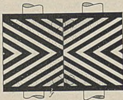
Abb. 7. Schematische Darstellung eines Pfeilradpaares bei Rückwärtsgang.
