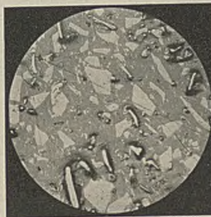
Abb. 3. Staub unter 0,088 mm (Reliefschliff, v = 120).
