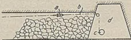
Die Umlenkrolle *a* ist an dem in seiner Länge veränderlichen Zugmittel *b* befestigt, das über den Versatz hinweg zu der Winde *c* geführt ist, die in der hinter dem versetzten Raum befindlichen Strecke *d* aufgestellt ist.
